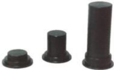
CryoChamber 盖有三种型号，以适用于不同的麦管和安瓿瓶标准型：20mm 高，适用于大多数标准的 $\frac{1}{2}$ ml 或 $\frac{1}{4}$ ml 麦管, 和 1ml 或 2ml 安瓿瓶。（产品编号: SL）
